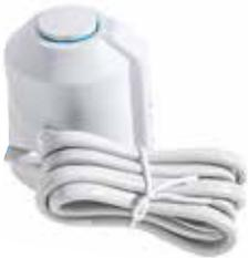
Leistungsmerkmale: Ausführung in stromlos-zu (NC), Patentierter 100 % Schutz bei undichten Ventilen, Rundum-Funktionsanzeige, Mit „First Open“-Funktion, Steckmontage, Ventil-Adapter-Konzept, Betriebsleistung 2 Watt, Schließ- und Öffnungszeiten ca. 3 min., Einfache Steckmontage, 360° Montagelage, Geringe Installationshöhe (59,1 mm), Schutzart IP 54, Rundum-Funktionsanzeige, Hohe Überspannungsfestigkeit.
