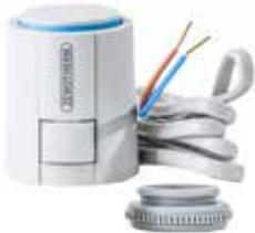
Leistungsmerkmale: Ausführung in stromlos-zu (NC), 1 Watt Leistungsaufnahme, Vollständige Kompatibilität zum Ventil-Adaptersystem, Einfache Steckmontage, 360° Montagelage, Patentierter 100%-Schutz bei undichten Ventilen, „First-Open“-Funktion, Geringe Installationshöhe (57,3 mm), TÜV-zertifiziert, CE-konform, Schutzart IP 54, Rundum-Funktionsanzeige, Überspannungsgarantie
