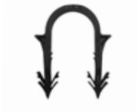
Tackernadeln aus schlagfestem Kunststoff mit Folienkralle (1) sowie aktivem 8-Ankersystem (2) gemäß EU-Norm 1264-4. Diese sorgen für perfekten Halt des Heizrohres direkt auf der Gewölbefolie. Passend für den ratiodämm Systemtacker und andere handelsübliche Tackergeräte. Für Rohre bis 20 mm Durchmesser.
